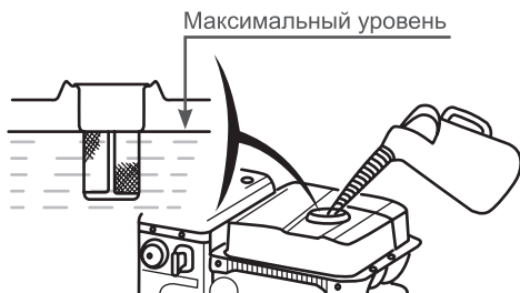
Рис. 2 Максимальный уровень топлива в топливном баке
