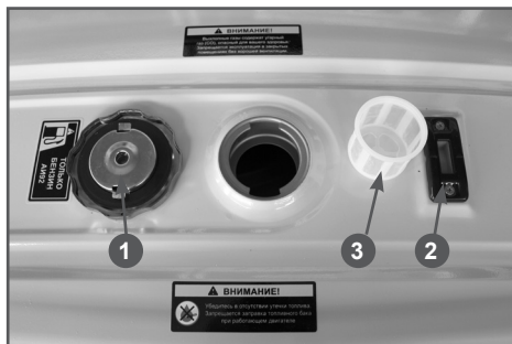
Рис. 3 Основные элементы топливного бака
