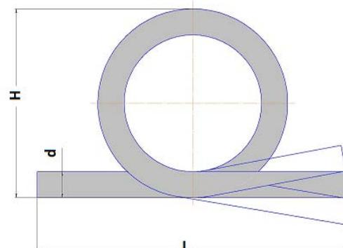
Схема установки компенсатора
