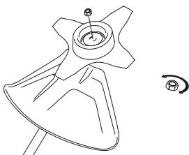
При ослаблении и затягивании гайки лезвия для пиления, рука может быть травмирована зубьями лезвия. Страйтесь, чтобы при этой работе ваша рука всегда была защищена щитком лезвия. Эта задача облегчается за счет использования длинного торцового ключа. На иллюстрации стрелкой показан участок, в котором следует располагать торцовый ключ при ослаблении и затягивании гайки.
