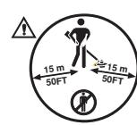
Машины, оснащенные подрезчиками или лезвиями для резки травы, может резко бросать в сторону, когда лезвия входят в контакт с закрепленным объектом. Это называется отдачей. В результате контакта с лезвием можно потерять руку или ногу. Всегда следите, чтобы люди и животные находились на расстоянии не менее 15 м от машины.
