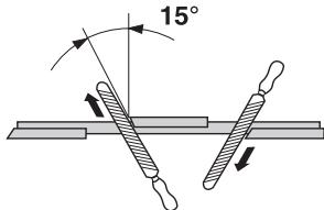
Отрегулируйте разводку. Она должен составлять 1 мм.
