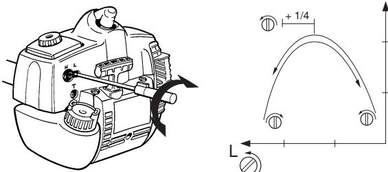
**ВНИМАНИЕ!** Если режущее оборудование вращается или подвижно при работе на холостых оборотах, винт **T** следует вращать против часовой стрелки до тех пор, пока режущее оборудование не остановится.
