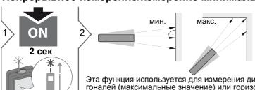
Эта функция используется для измерения диагоналей (максимальные значение) или горизонтальных расстояний до вертикальной поверх
