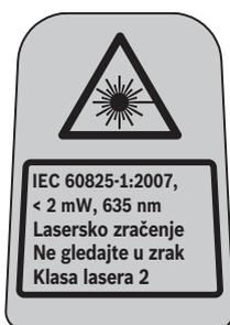
Merni alat se isporučuje sa tablicom i opomenom na nemačkom jeziku (na prikazu mernog alata na grafičkoj strani označeno sa brojem 4).
